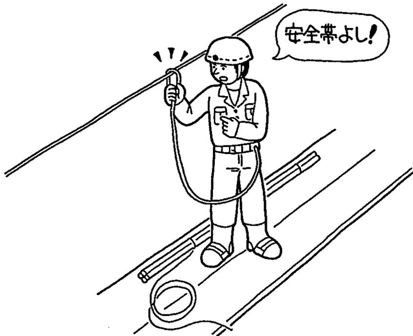
B. 部材の固縛状態や手やすロープのより、ねじれを確認する。
