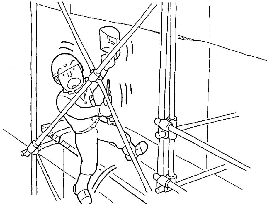
D. 手摺と作業床の隙間から墜落する。
