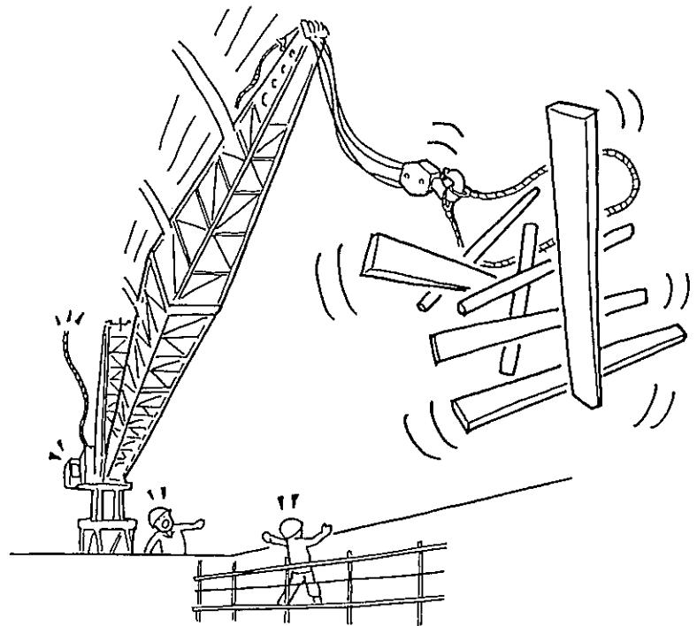
D. ジブが艤装作業中の船上に落下。
