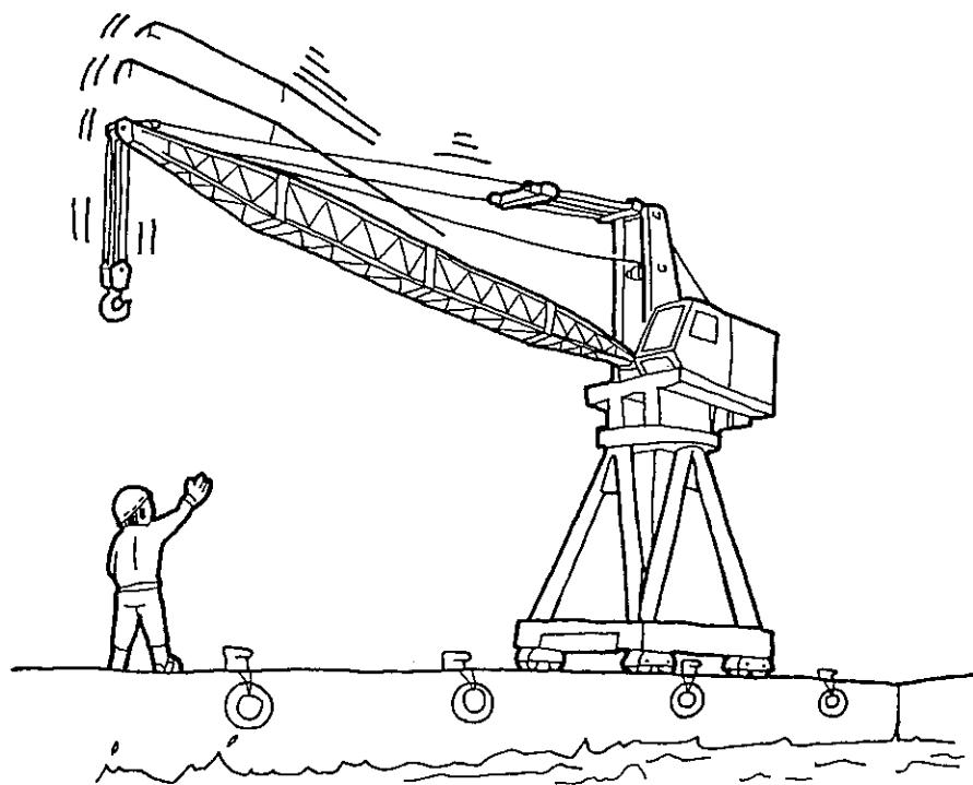
B. 起伏ワイヤーのエンドがロープウェッジより抜け、ジブが落下する。
