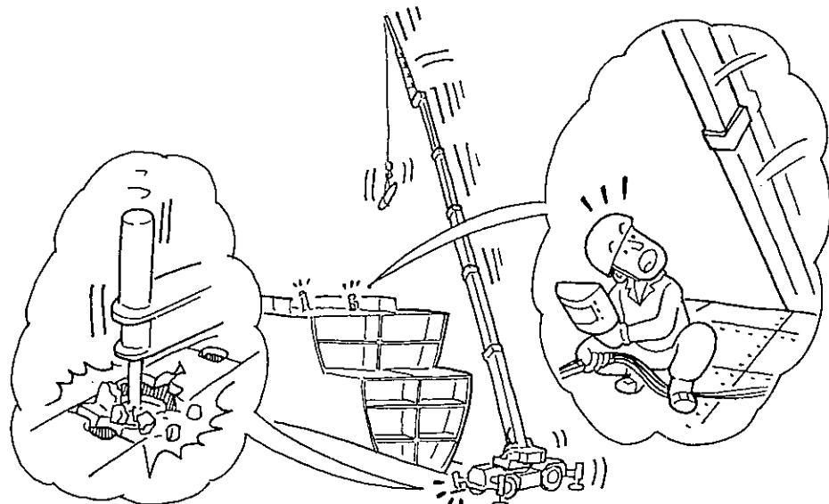
D. 側溝カバーが崩れクレーンが転倒し、
