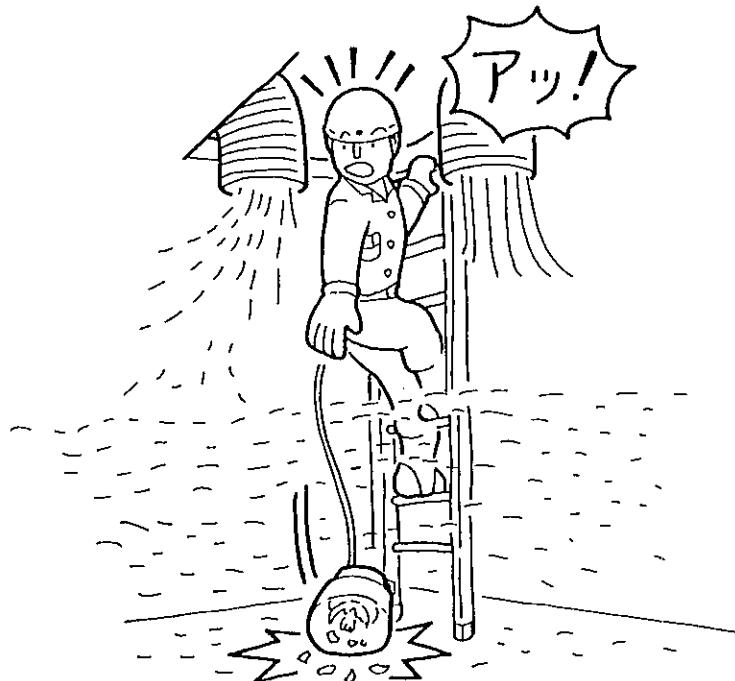
D. 電球が割れ、爆発限界を越えていた溶剤ガスに引火、
