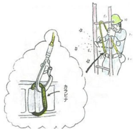
垂直梯子のステップを取替え作業中、安全帯のフックを工具掛け用カラビナにかけていたため、カラビナが荷重に耐え切れず破損し、約11m下のタンク底部に墜落
