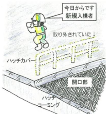
入構初日で深残業をしていた被災者がトイレに行くため歩行中、検査のために手摺りが一時取り外されていたハッチカバー開口部から、5.5m墜落
