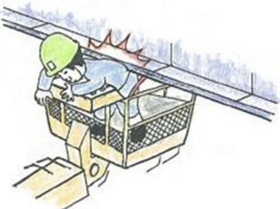
高所作業車でタッチアップ塗装中、上甲板付補機台と高所作業車の操作盤に胸を挟まれた
