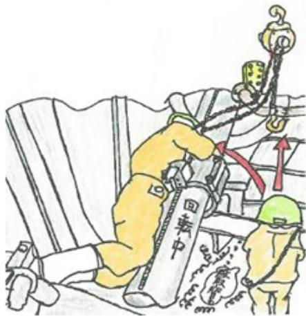
回転中のボーリング機を止めるため、ボーリング機の横を通り抜けようとした際に、回転部に安全帯の子綱が巻き込まれ、さらに付近のチェーンブロックのチェーンが巻き付き頸部を締め付けられた
