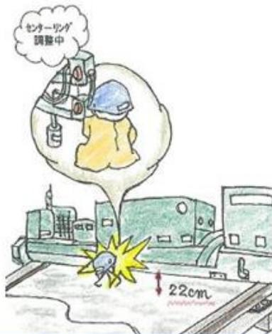
NC切断機のセンタリング調整中、起動ボタンを押したため本体が動き、切断機と台座の隙間に胸を挟まれた
