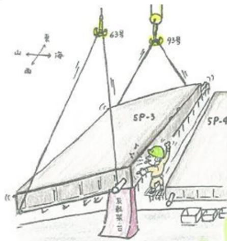
相吊りでハッチカバーの反転作業中、吊り上げたハッチカバーが反転架台から外れたので、確認しようとしたところ、荷が振れ、隣接するハッチカバーとの間に挟まれた
