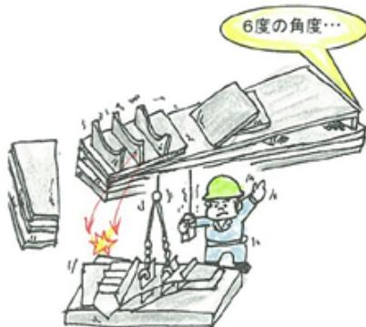
天井クレーンを操作して、小組材の運搬作業中、他部材の上に仮置きした小組材が約1mの高さから滑り落ち、作業者の胸を直撃した
