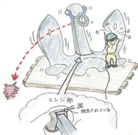
アンカーストックのヒンジに泥が詰まりアンカーを寝かせられない状態だった。アンカーの塗装を高圧水ではく離作業中、ヒンジ部の泥が取れ、ストックが動き、アンカーが転倒。ツメ部分と渠底の間に頭を挟まれた
