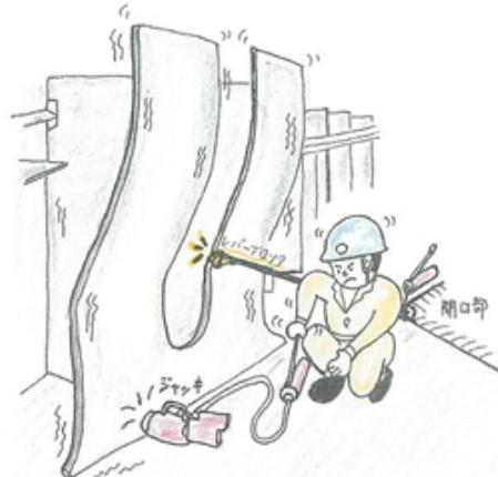
倒壊防止は必要ないと判断した自立する小組部材(1.5トン)を正規位置に合わせるため、足元にレバーブロックと油圧ジャッキをセットし、レバーブロックで引き寄せた際、部材が倒れ下敷きとなつた
