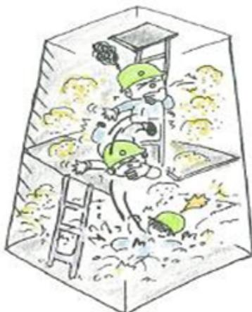
扉船のボイドスペース内に溜まった海水を抜く為、酸素濃度を確認せずにマンホールから内部に入ったところ、酸欠により倒れ、底部に溜まっていた海水中に落下した
