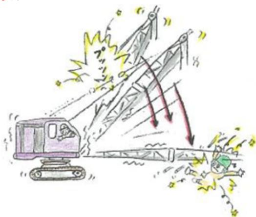
休止中のクローラクレーンを使用し、足場材を運搬しようとしたところ、ジブ保持用ワイヤーが切断し、ジブおよび吊り荷が落下、下敷きになった
