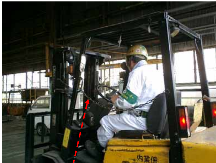
金属製引っ掛け式チェーン ( 構内の全フォーク・リフトに標準装備 )
