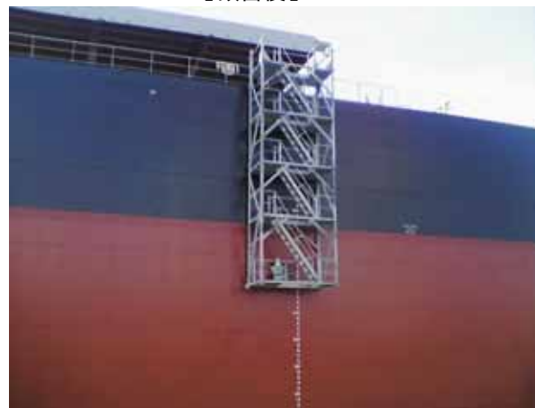
(艀装船引っ掛け作業架台)
