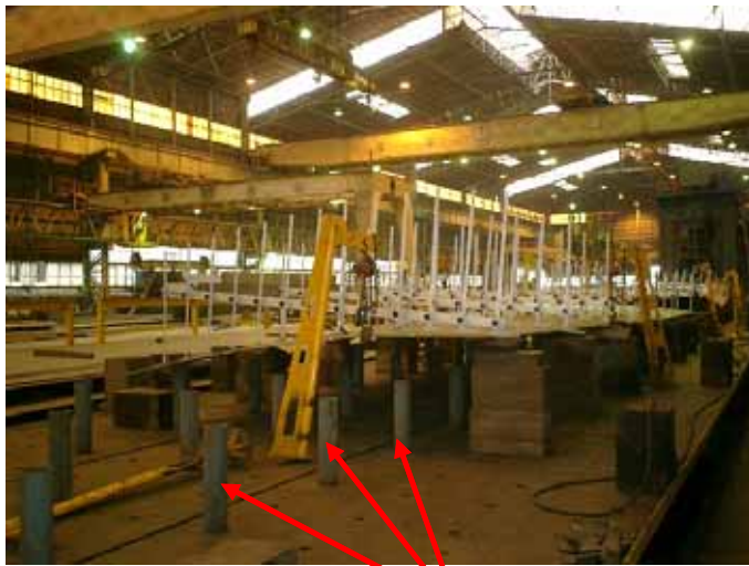
蜂の巣定盤上に取付けの鋼板落下防止用のピラー (ぎょう鉄作業定盤上の鋼板落下防止ピラー)
