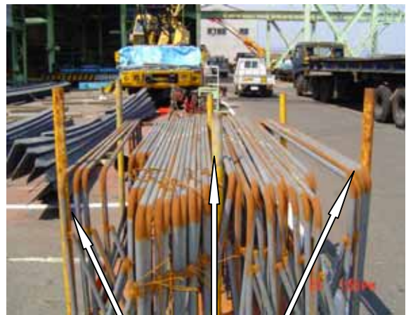
パイプスタクション
