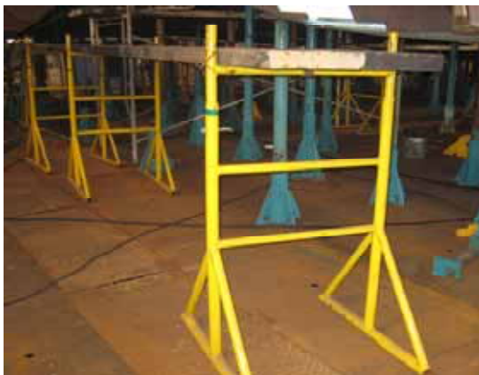
(ブロック端部の仮設ステージ用馬台)
