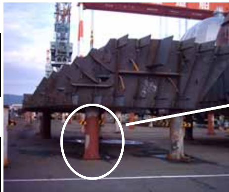
(ブロック受け用 鋼製盤盤木フォーク受け部の注意表示)
