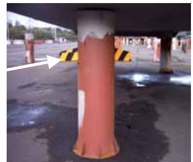
(ブロック受け用 鋼製盤盤木フォーク受け部の注意表示)
