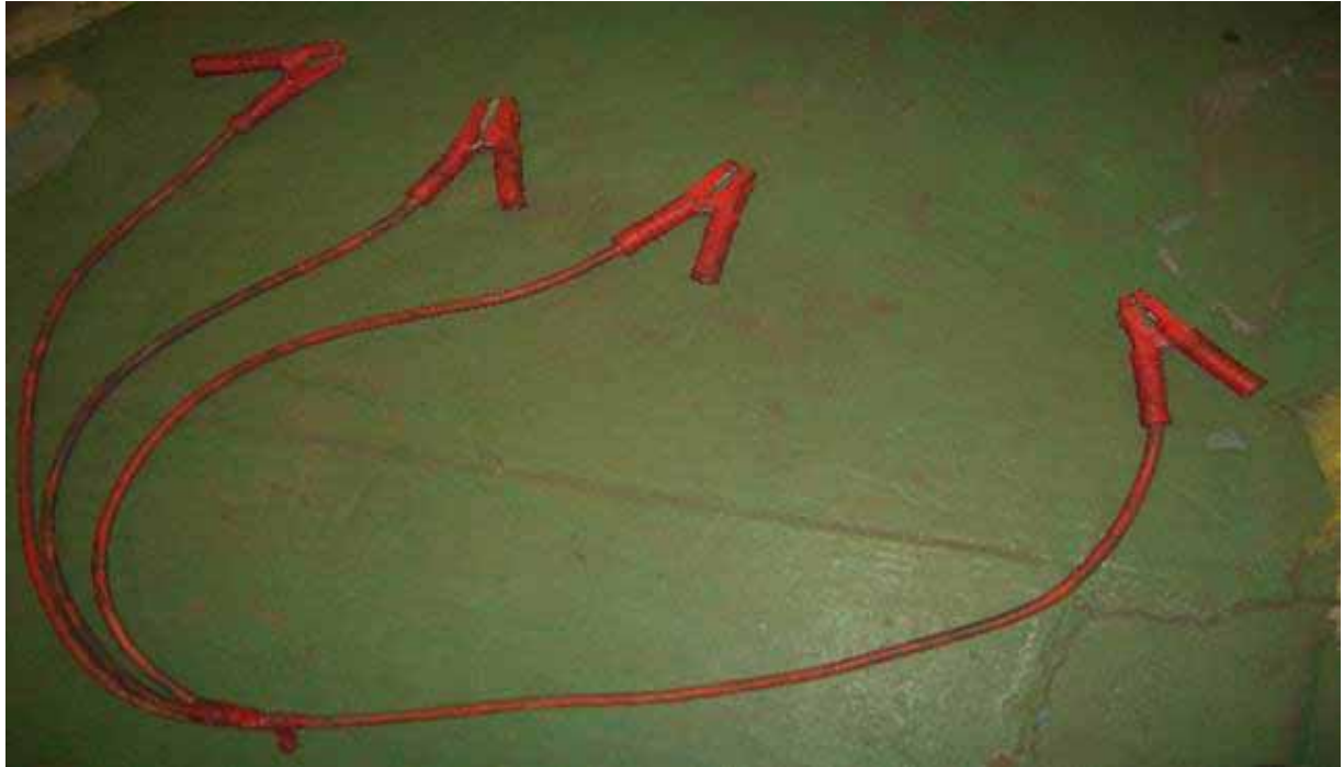
（天井クレーン修理時のアース線）
