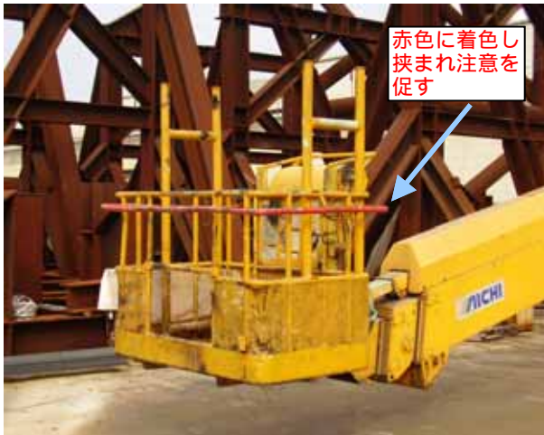
(高所作業車挟まれ防止用ガード塗装)
