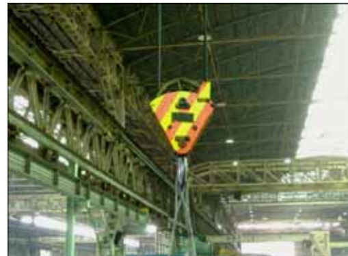
天井クレーンのフックには、蛍光色黄色と蛍光色オレンジのストライプとした。
