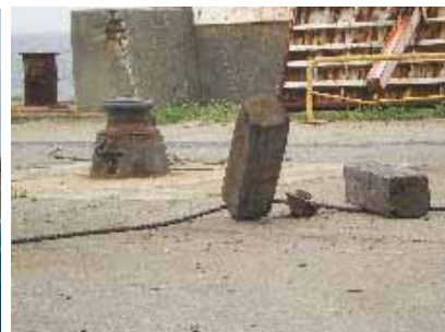
③ロープが切れ、係船索と滑車が飛び、木材が倒れる。
