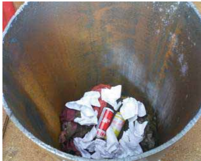
①スプレー缶と可燃物を衝撃に強い入れ物にいれ、火をつける
