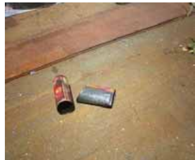
③爆発したスプレー缶（缶の底と上部が破損）
