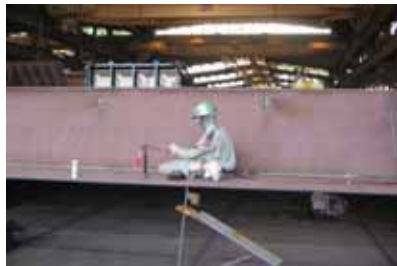
①マネキンにガス切断器を持たせる。亀裂のあるガスホース内にガスを充填させる。
