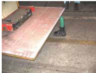
①ゴミが付着した880Kgの鉄板をリフティングマグネットで吊る。
