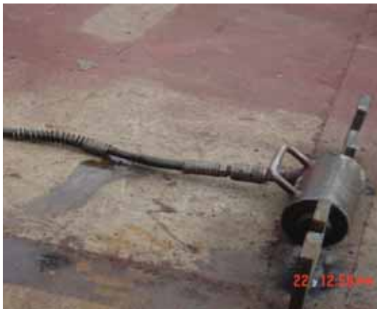
①作動油のホースの被覆の剥れた油圧ジャッキを準備し、圧をかけておく。
