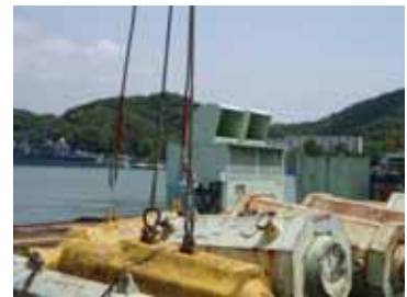
②吊りワイヤーを同じ撚り（Zヨリ）の2本で2点吊りしても、1点吊りと同じく荷も吊りワイヤーも回転した
