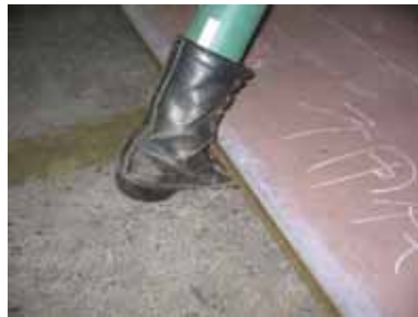
②ゴミにより吸引力が下がり、リフティングマグネットから離れ、足元に落下する。
