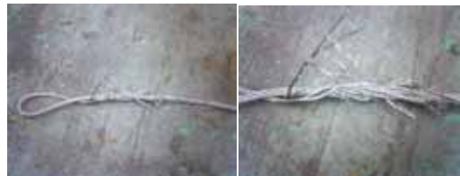
③編込み部のヨリが抜けて吊り荷が落下した
