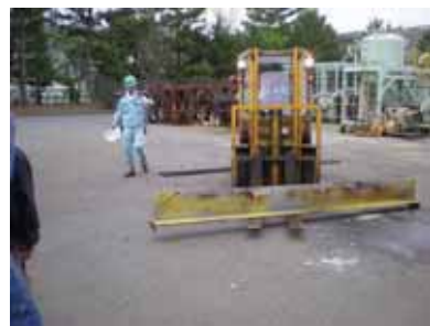
③長尺物の運搬 (爪の間隔、重心位置、左右の障害物の確認)
