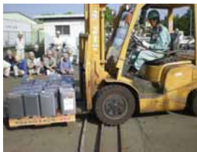
②塗料パレットを運搬 (凹凸路面からの衝撃)
