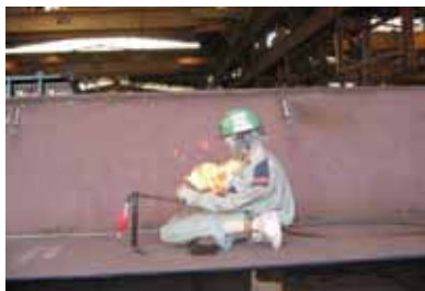
②ガスホースの亀裂部分に点火し、ホース内の充填ガスが燃烧して、それを作業服に燃え移らせる。
