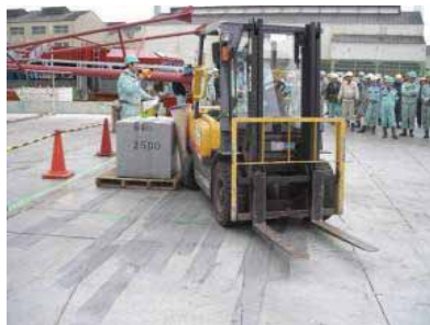
②フォークリフトの旋回範囲と後部車体による挟まれ (操作前の周囲の確認不足)
