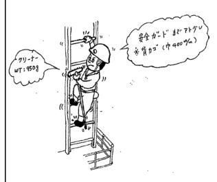
\*垂直タラップ最上段の安全ガードの隙間から墜落した。
